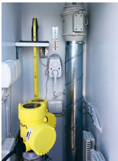
Mätstation för vattenstånd vid Kungsholmsfort samt mätutrustning inuti stationen vid Landsort Norra.
