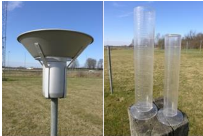
Figur 2. Dagens nederbördsräkare med vindskydd för manuell nederbördsräkning till vänster och mätglas för att mäta mängden nederbörd till höger.
