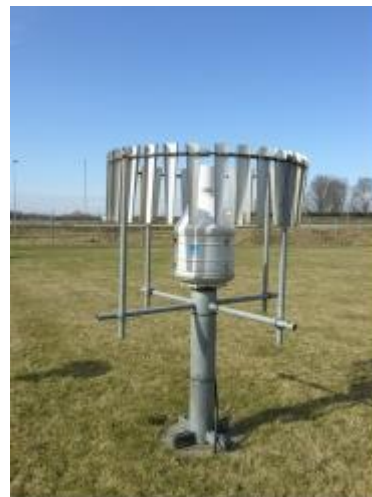
Figur 3. Nederbördsräkare vid automatiska stationer av typ Geonor.
