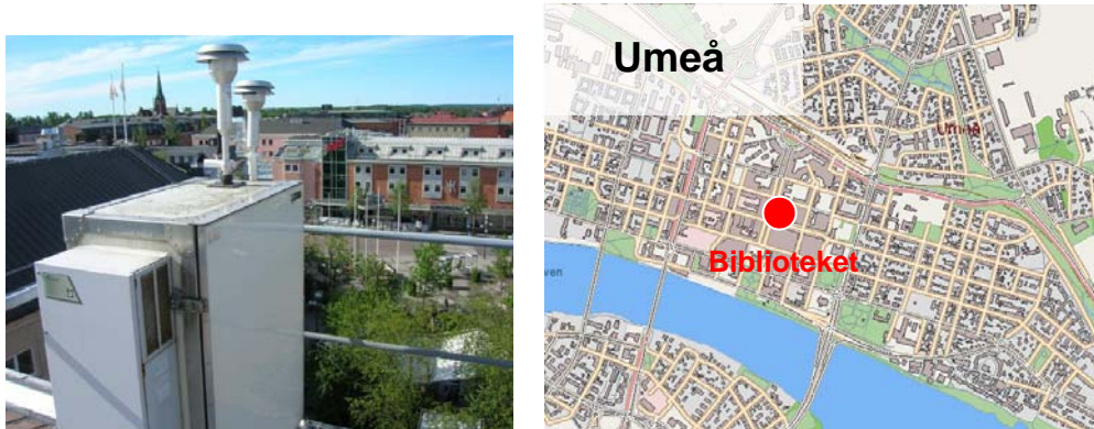
Figur 6. Umeå kommun utför mätningar i urban bakgrund på bibliotekets tak i centrala Umeå.
