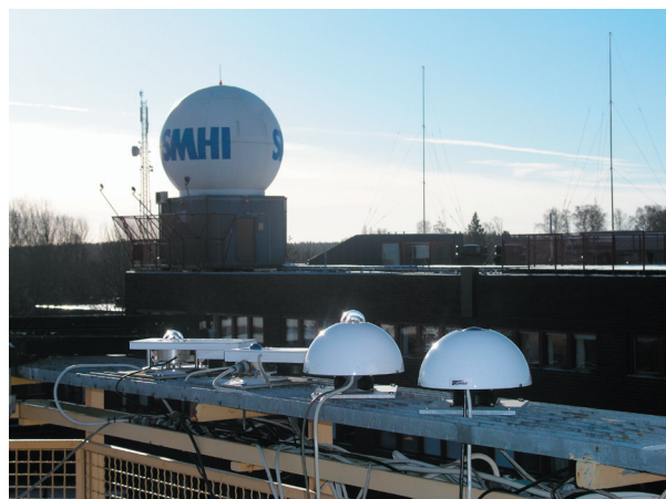
Instrument för mätning av globalstrålning (glaskupoler) och långvägsstrålning (filter). Fläkthus (vita) ser till att frost och dagg inte bildas.
