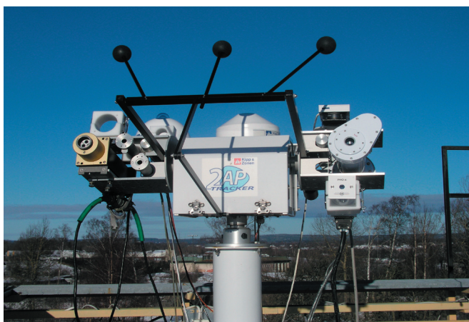
Instrument för mätning av direkt solstrålning och AOD hålls riktade mot solen av en solföljare. Andra instrument skuggas av klot för att mäta den diffusa solstrålningen
