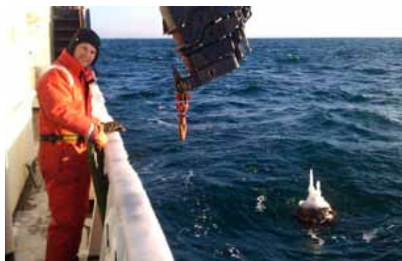
Upptagning av nedisad boj vid Väderöarna. Under isklumpen sitter antenner som används för att skicka data via satellit till SMHI.
