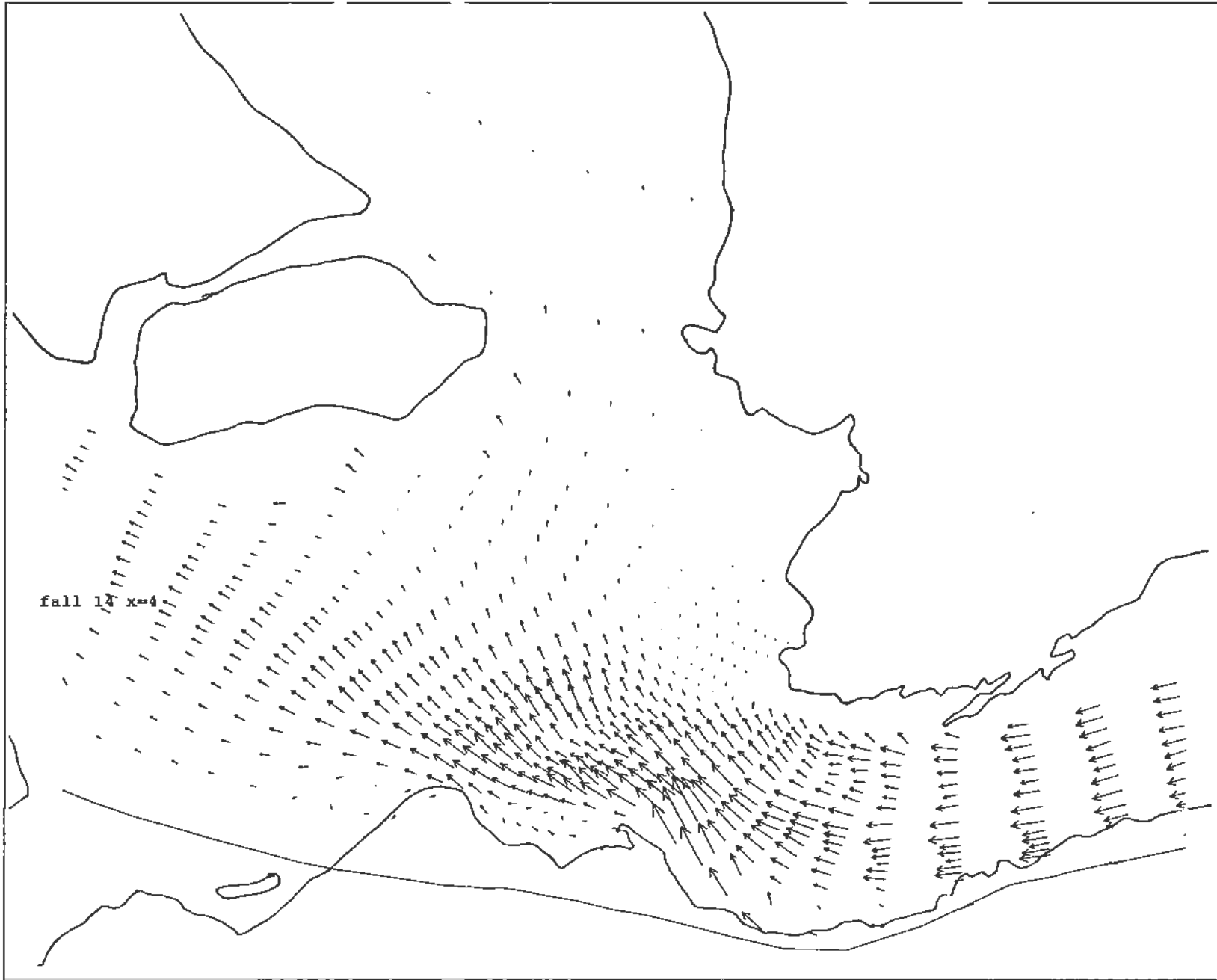
Figur 14 Simulerade strömmar i skiktet närmast under isen; fall 14, W=-0.5 m, Q=3100 m 3 /s, ej is, muddrad grop.
