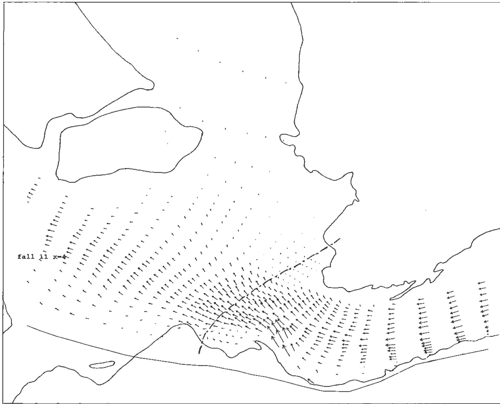
Figur 11 Simulerade strömmar i skiktet närmast under isen; fall 11, W=+0.5 m, Q=2500 m 3 /s, fast is, muddrad farled.
