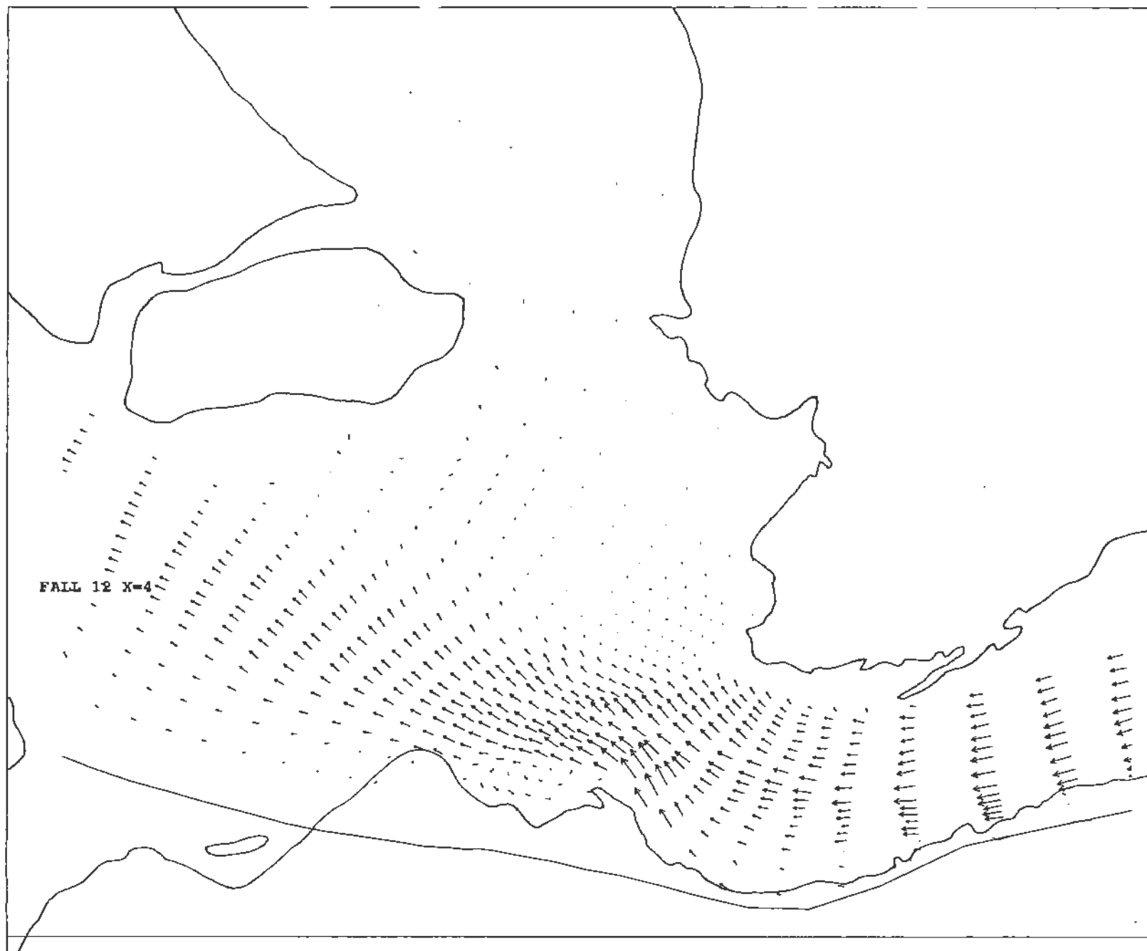
Figur 12 Simulerade strömmar i skiktet närmast under isen; fall 12, W=+0.5 m, Q=2500 m 3 /s, ej is, muddrad farled.
