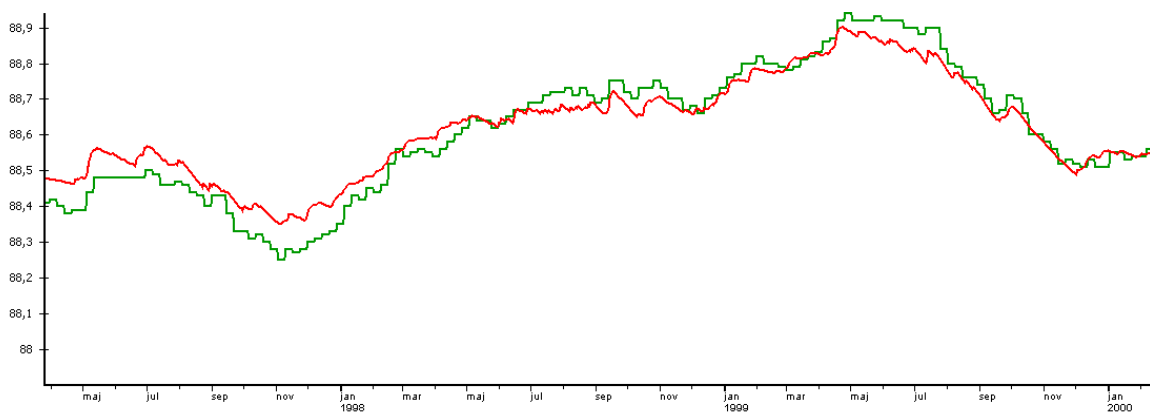
Figur 21. Exempel på kalibreringsresultat för HBV-modellen. Grön linje observerat naturligt vattenstånd under perioden maj 1997 till januari 2000 och röd linje modellerat vattenstånd. Det observerade vattenståndet är visat som veckomedel, medan det beräknade är dygnsmedel.
